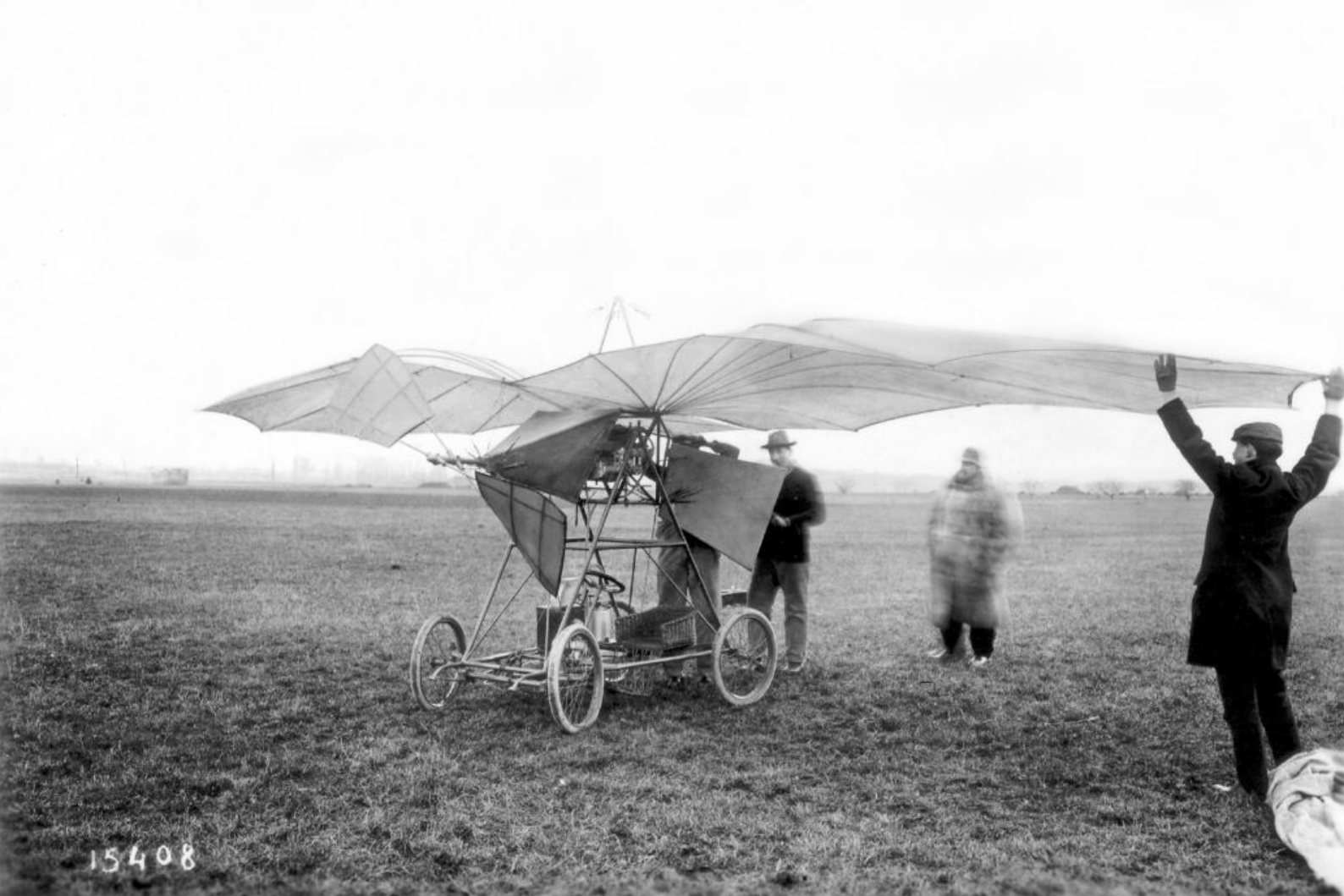
Traian Vuia și Aparatul Vuia 1 cu care a realizat la 18 martie 1906 pe o șosea de lângă Montesson acel mic zbor, salt pe o distanță de 12 m, „efectuat exclusiv cu mijloacele instalate la bord, decolarea s-a efectuat de pe roți fără a recurge la vreun impuls din exterior”
