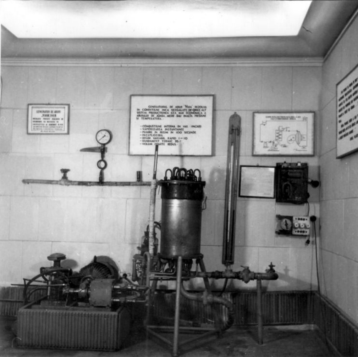
Generator de abur "Vuia". Instalație fixă la Institutul de Documentare Tehnică al Academiei Române
