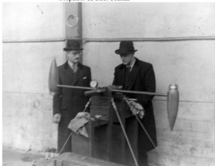
Propulsor cu efect Coandă
