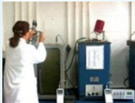
Etalonare prin comparare în băi cu lichid
